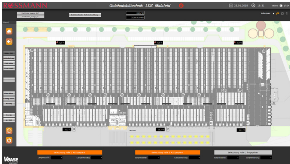
Visualisierung der Hallenbeleuchtung.
